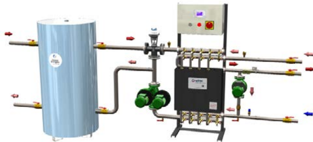
Branchement traversant préconisé uniquement avec le ballon du Pack Santé de SPIREC
