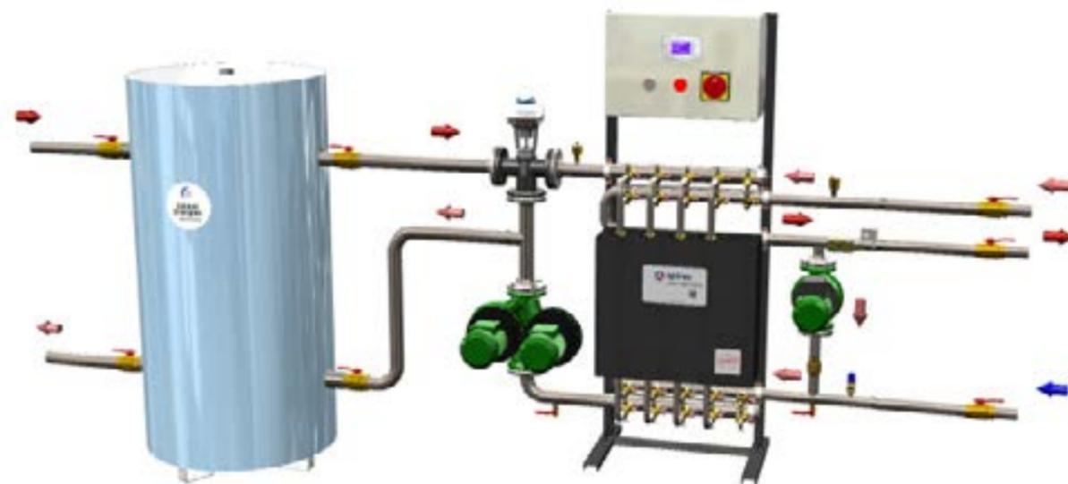
Schéma de branchement traversant préconisé uniquement pour les ballons du PackSanté de SPIREC
