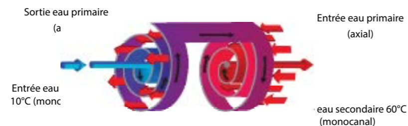
Schéma de principe de l'échangeur SPIREC : le secondaire circule dans un circuit monocal
