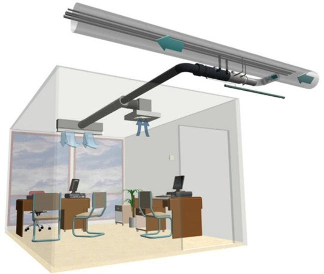
Batteries 2 ou 4 tubes pour assurer le confort, associées parfois à de l'induction pour améliorer le brassage. Les batteries peuvent venir en complément d'un traitement de base effectué par un autre système CVC (dalle active, plafond froid...) pour déshumidifier l'air neuf ou apporter un complément de puissance.
