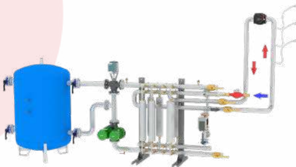
Schéma d'une installation de production d'ECS instantanée avec stockage primaire Branchement traversant préconisé uniquement avec le ballon Pack Santé
